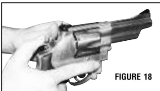
**WARNING: FAILURE TO REMOVE YOUR FINGER FROM THE TRIGGER GUARD AS SOON AS THE HAMMER RELEASES COULD CAUSE THE REVOLVER TO FIRE IF YOUR THUMB SLIPS OFF OF THE HAMMER SPUR.**
