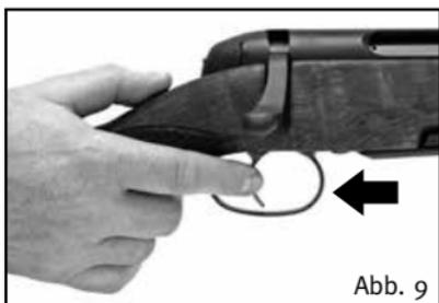
Durch Antippen des Abzuges springt dieser in die Ausgangslage zurück, wodurch der Schuss ausgelöst wird. Ungestochen ist der Rückstecher als Flintenabzug zu benutzen.
