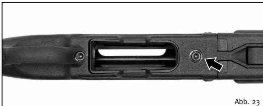
Werden diese Schrauben gelöst, müssen sie mit einem Drehmoment-schlüssel (7 Nm) festgezogen werden.
