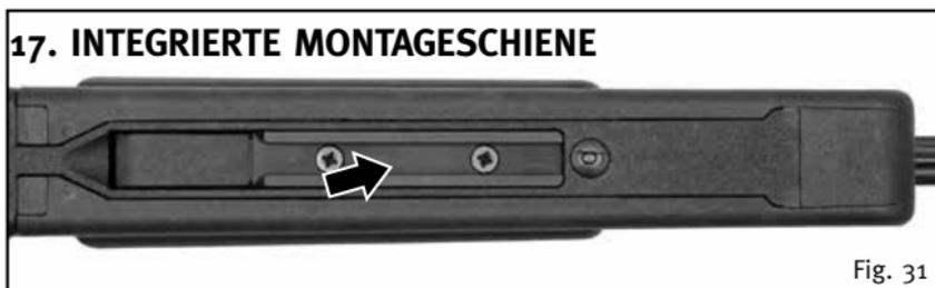
An der vorderen Unterseite des Schaftes ist eine Montageschiene befestigt an der verschiedenenes Zubehör wie Zweibein, Scheinwerfer, Handstop, Zielgeräte usw. montiert werden kann.
