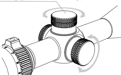
La lunette de visée Athlon Neos a 1/4 MOA pour les valeurs en clics de l'ajustement d'élévation et de dérive selon les différentes configurations de sélections de réticule et des portées. MOA est une unité de mesure angulaire définie comme une minute d'angle, une minute est 1/60ème de degré et 1/21600ème d'un cercle. Un MOA correspond à 1,047 pouce (arrondi à un pouce) à 100
